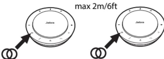
Чтобы отсоединить спикерфоны, нажмите кнопку **Соединение** на одном из спикерфонов.
