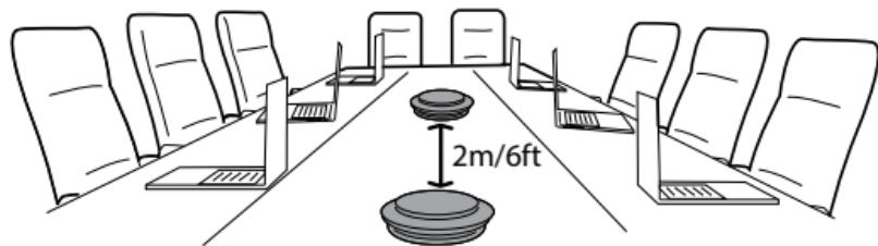
Для временного включения звуковой связи между двумя спикерфонами Jabra Speak 710 нажмите кнопку **Соединение** на обоих спикерфонах, если они находятся на расстоянии не более 2 м друг от друга.
