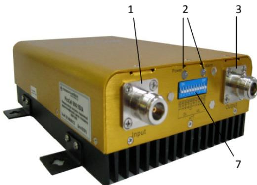
Внешний вид ретранслятора показан на рисунках 1 и 2. Корпус выполнен из алюминиевого сплава что позволяет одновременно обеспечить механическую прочность, хороший тепловод и необходимую экранировку от разных помех.
