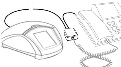
Отсоедините кабель телефонной трубки от корпуса телефона и подсоедините его к телефонному адаптеру, как показано на рисунке ниже.
