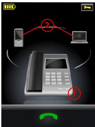
**1. Текущий выбранный телефон:** этот большой значок обозначает телефон, соединение с которым откроется при **быстром нажатии** многофункциональной кнопки гарнитуры или значка зеленой телефонной трубки в нижней части экрана. **Дважды нажмите** многофункциональную кнопку гарнитуры для повторного набора на этом телефоне (только выбранные программные и мобильные телефоны).
