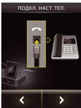
Рис. 24: Подсоединение к разъему для подключения телефонной трубки
