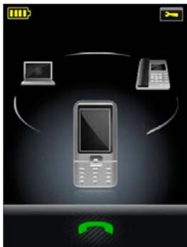
4. После повторного подключения мобильного телефона и базы (т.е. при помощи базы также восстановлено соединение с гарнитурой) значок выбранного мобильного телефона не будет серым, как показано на рисунке слева.
