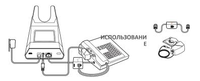
**ВНИМАНИЕ!** Для телефонов **Cisco** используется конфигурация **D** в нижней части базовой станции. Для большинства других телефонов используется конфигурация по умолчанию **A**.
