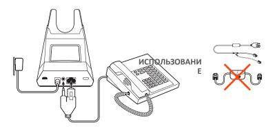
**ВНИМАНИЕ!** Используйте конфигурацию **А** в нижней части базовой станции, которая подходит для большинства телефонов, в том числе телефонов Cisco.
