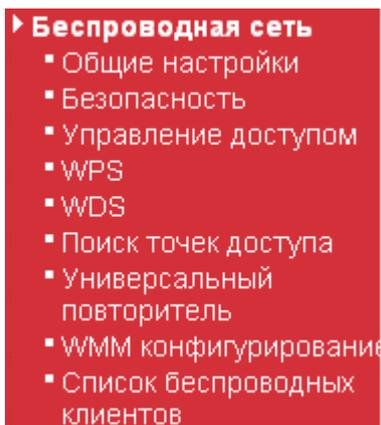
Откройте **Беспроводная сеть**>>**Универсальный повторитель**. Более подробную информацию вы найдете в соответствующей секции.
