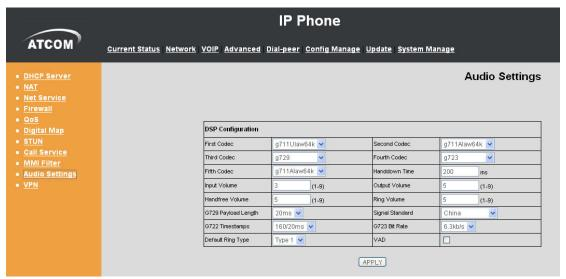
First Codec: The fist preferential DSP codec: G.711A/u、G722、G.723、G.729 Second Codec: The second preferential DSP codec: G.711A/u、G722、G.723、G.729
